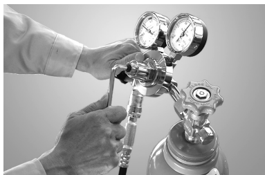
▲二次側圧力の調整
