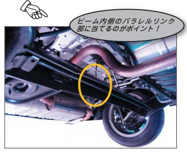
※ 2WD 車は、年式によりジャッキ箇所が変更されている。 前期モデル(~平成 24 年 8 月迄)は、黄色囲み部が 突起部位(三角錐形)となる。
