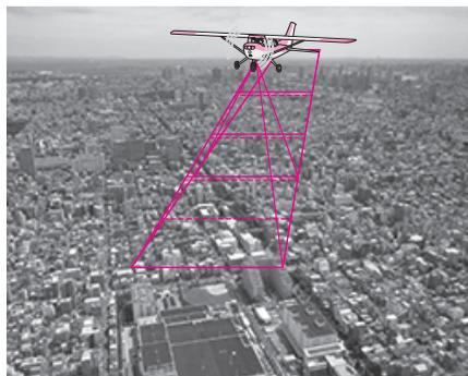
起伏のある土地を空中写真測量で撮影した場合、対象物の高さが**低い**ほど地上画素寸法は**大きくなる**ため、同一写真の中でも地上画素寸法が異なる。
