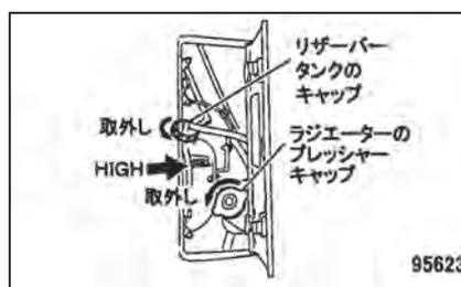
④再びエンジンを始動し1分後にウォーターポンプを作動させ、右図要領でエンジンを5分間回転させる。冷却水が不足している場合は、プレッシャーキャップの口元まで冷却水を補充する。冷却水が減らなくなるまで上記作業を繰り返し行う。エア抜きコックを閉じる。
