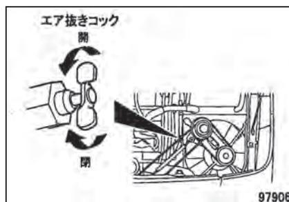
③プレッシャーキャップを取外し、冷却水をプレッシャーキャップの口元まで補充する。エンジンを始動し1分後にウォーターポンプを作動させる。
